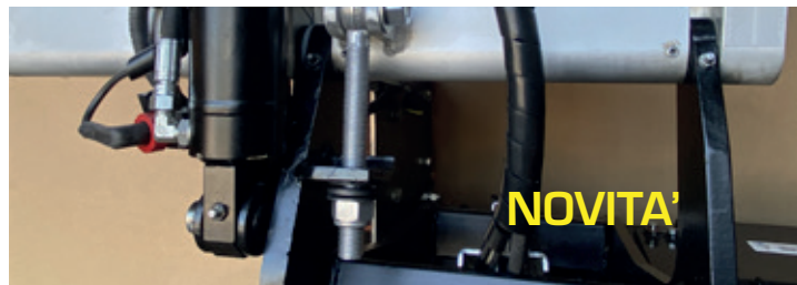
SISTEMA ANTIVIBRAZIONE DELLA PIATTAFORMA (EVITA L'INSTALLAZIONE DI TAMPONI IN GOMMA SULLE PORTIERE)
