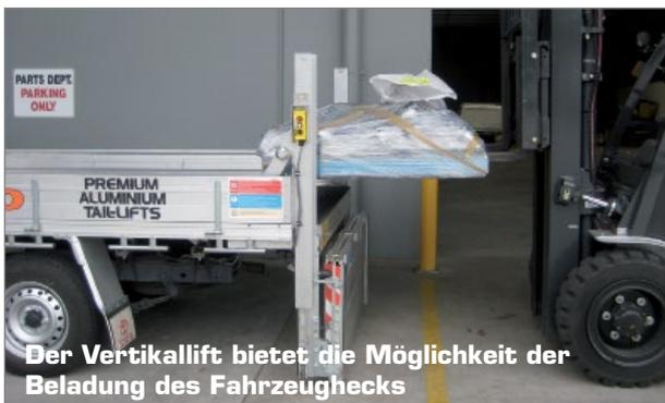
Der Vertikallift bietet die Möglichkeit der Beladung des Fahrzeughecks
