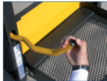
Interrupteur de montée et de descente installé sur rambarde
