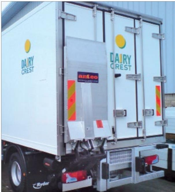
Die klassischen F3MH 075 Ladebordwände für geschlossene Fahrzeuge . (Die Mindestbreite muss entsprechend der Fahrgestellbreite überprüft werden).
