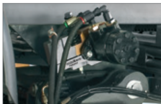
Motor hidráulico y freno (patentado)
