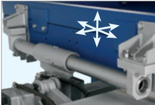
La guía cromada puede ser ajustada en modo longitudinal, horizontal y vertical.
