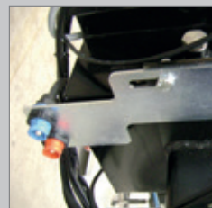
42 Conexiones eléctricas VE HH para centralita hidráulica estanca cableada (en la empresa).
