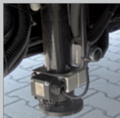
29 Sistema de alarma acústica para estabilizadores hidráulicos.
