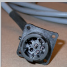
41 Conector VE HH para interruptor en cableado cabina (en la empresa).
