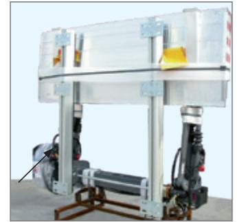
**24** Hayon rétractable entièrement monté en usine.
