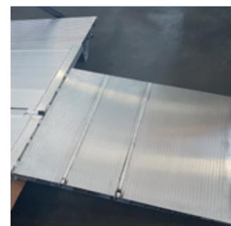
**53 Rampes latérales amovibles pour les hayons rétractables** (rampes fabriquées en aluminium à haute résistance)
