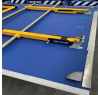
**43** Hayons silencieux avec certification PIEK. Il comprend un bloc d'alimentation silencieux, un revêtement insonorisant pour la plate-forme et des arrêts de chariot automatisés.
